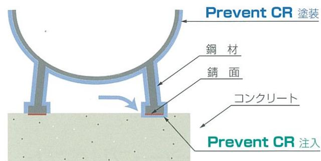
コンクリート土台上的鋼構造物の底部に発生した錆も「Prevent CR」を注入する事で防食処理が可能になりました。
