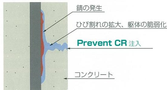
「Prevent CR」は低粘度なため注入が容易であり、クラック部、接合間隙部などに容易に浸透します。
